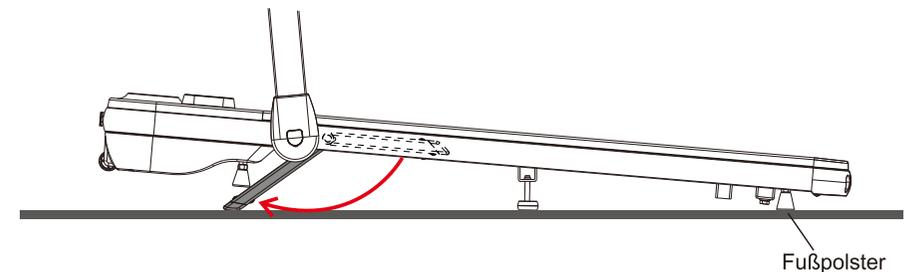
2. Wie im untenstehenden Diagramm gezeigt, wenn der Neigungsfuß ausgeklappt ist und das Fußpolster in der im Diagramm gezeigten Position installiert ist, verringert sich der Winkel zwischen dem Laufband und dem Boden, wodurch die Neigung verringert wird. (Stellen Sie sicher, dass das Fußpolster in der Mitte den Boden berührt.)
