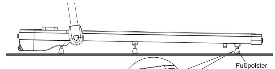
Installationsmethode: Entfernen Sie die originalen Fußpolster und installieren Sie sie in den Schraubenlöchern in der in der Abbildung gezeigten Position, um die Neigung des Laufbands zu verringern.
