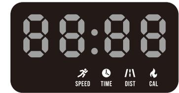
Während des Betriebs wechselt die LED-Anzeige automatisch alle 5 Sekunden, um diese Metriken anzuzeigen.
