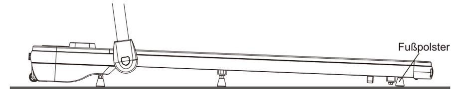
2. Wie unten gezeigt, wenn die Fußpolster in der Position unter dem Laufband installiert sind, verringert sich der Winkel zwischen dem Laufband und dem Boden und verringert somit die Neigung. (Stellen Sie sicher, dass das Fußpolster in der Mitte den Boden berührt.)
