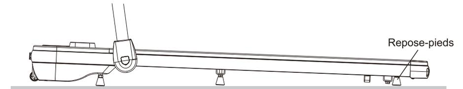
2. Comme indiqué ci-dessous, lorsque les tampons de pied sont installés dans la position sous le tapis roulant, l'angle entre le tapis roulant et le sol diminue, réduisant ainsi la pente. (Assurez-vous que le tapis de pied au centre touche le sol.)
