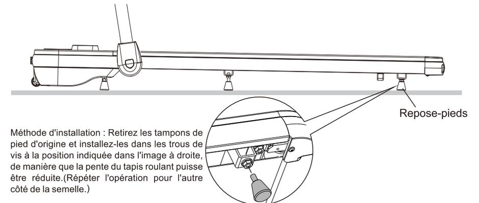
Méthode d'installation : Retirez les tampons de pied d'origine et installez-les dans les trous de vis à la position indiquée dans l'image à droite, de manière que la pente du tapis roulant puisse être réduite. (Répéter l'opération pour l'autre côté de la semelle.)
