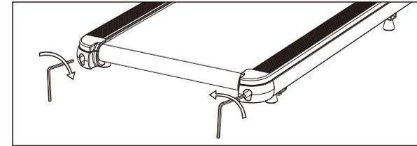
Si la bande se dévie vers la gauche : Ajustez le boulon gauche dans le sens des aiguilles d'une montre ou le boulon droit dans le sens antihoraire.
