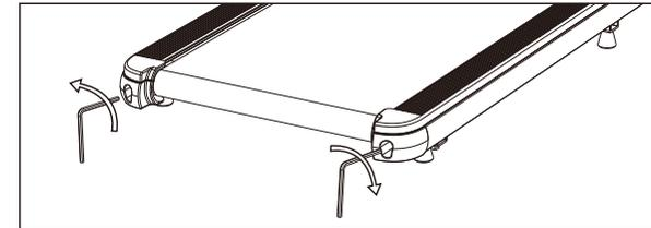
Si la bande se dévie vers la droite : Ajustez le boulon droit dans le sens des aiguilles d'une montre ou le boulon gauche dans le sens antihoraire.
