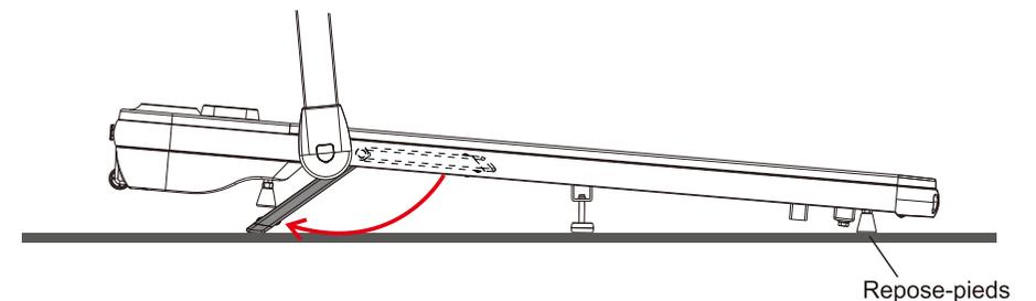
2. Comme montré dans le diagramme ci-dessous, lorsque le pied d'inclinaison est déplié et que le tapis de pied est installé à la position indiquée dans le diagramme, l'angle entre le tapis de course et le sol diminue, ce qui réduit l'inclinaison. (Assurez-vous que le tapis de pied au centre touche le sol. Répétez l'opération pour l'autre côté de la semelle.)
