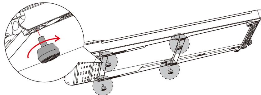
2. Stellen Sie nach der Installation der Fußpolster sicher, dass alle Fußpolster unten bündig mit dem Boden abschließen.
