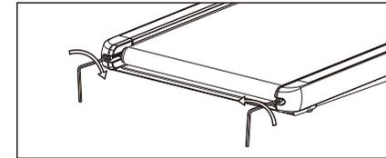
Wenn das Band nach links abweicht: Stellen Sie die linke Schraube im Uhrzeigersinn oder die rechte Schraube gegen den Uhrzeigersinn ein.
