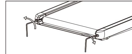
Wenn das Band nach rechts abweicht: Stellen Sie die rechte Schraube im Uhrzeigersinn oder die linke Schraube gegen den Uhrzeigersinn ein.
