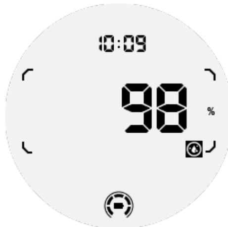
正確な測定を行うため、血中酸素濃度検出中は、装着のゆるみ、過度の傾き、揺れなどを避けてください。これらの条件が発生した場合、装置は「FAIL」を表示します。
