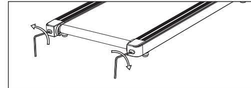
Wenn das Band nach rechts abweicht: Stellen Sie die rechte Schraube im Uhrzeigersinn oder die linke Schraube gegen den Uhrzeigersinn ein.
