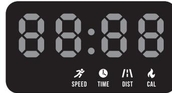
Während des Betriebs wechselt die LED-Anzeige automatisch alle 5 Sekunden, um diese Metriken anzuzeigen.
