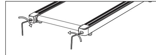
Wenn das Band nach links abweicht: Stellen Sie die linke Schraube im Uhrzeigersinn oder die rechte Schraube gegen den Uhrzeigersinn ein.
