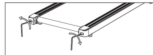
Si la bande se dévie vers la droite : Ajustez le boulon droit dans le sens des aiguilles d'une montre ou le boulon gauche dans le sens antihoraire.
