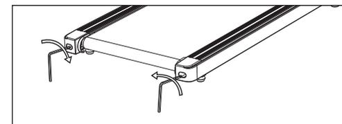
Si la bande se dévie vers la gauche : Ajustez le boulon gauche dans le sens des aiguilles d'une montre ou le boulon droit dans le sens antihoraire.
