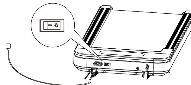
4. Pour déplacer le tapis de course, débranchez d'abord le cordon d'alimentation, puis soulevez l'arrière du tapis de course à la main, permettant aux roues de se déplacer sur le sol pour un mouvement avant et arrière.
