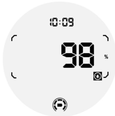
正確な測定を確保するために、血中酸素検出中に緩めの着用、過度の傾き、または振動を避けてください。これらの条件のいずれかが発生すると、デバイスは「FAIL」というメッセージを表示します。
