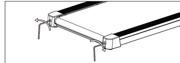
Si la banda se desvía a la derecha: Ajuste el tornillo derecho en sentido horario o el tornillo izquierdo en sentido antihorario.
