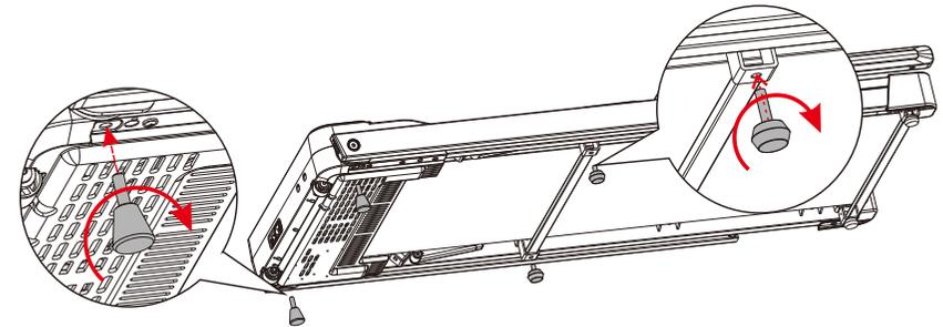
2. Como se muestra en el paso (A), utilice la llave hexagonal proporcionada para girar los tornillos de las columnas verticales izquierda y derecha en el sentido contrario a las agujas del reloj 3 o 4 vueltas hasta que los tubos de soporte se puedan levantar hacia arriba.
