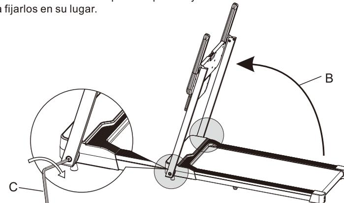
4. Como se muestra en el paso (D), gire el panel para conectarlo con las columnas verticales (evite presionar los cables de comunicación y tenga cuidado de no pellizcarse las manos durante la instalación). Como se muestra en el paso (E), use la llave hexagonal proporcionada para asegurar los tornillos de cabeza hexagonal M8\*12 y las arandelas planas para fijar el panel a las columnas verticales izquierda y derecha. Ajuste la pantalla a su posición preferida como se muestra en el paso (F).
