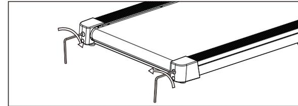
Si la banda se desvía a la izquierda: Ajuste el tornillo izquierdo en sentido horario o el tornillo derecho en sentido antihorario.
