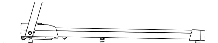
2. Para aumentar la inclinación, despliegue el pie inclinable plegable en la dirección indicada por la flecha hasta que alcance el punto límite. Luego, ajuste la almohadilla del pie central para que se ajuste firmemente al suelo. (Repita los mismos pasos para el otro lado.)
